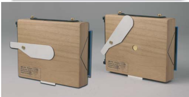
La MB 010 Pinhole Camera è una fotocamera ultrawide: la focale è di appena 25mm, con un angolo di campo di 140° che permette anche riprese di architettura. Il diaframma è f/126, con il diametro del foro di 0,20mm. La macchina è in legno massello con minuterie in ottone e monta un superbo otturatore di alluminio a ghigliottina.
